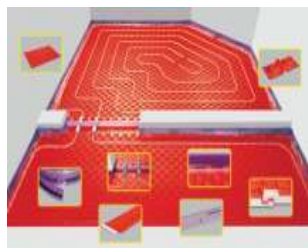
Es. Impianto riscaldamento a pavimento
